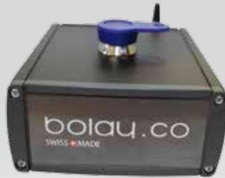
La communication est assurée par une liaison redondante GPRS permettant de palier à une panne éventuelle du réseau internet standard.
